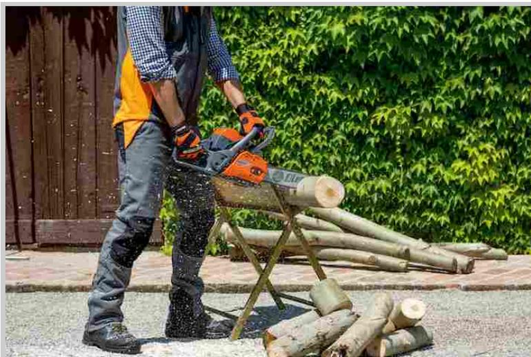
Il motore due tempi, premiato al Concorso Novità Tecniche 2018, è dotato di sistema di ricircolo dei gas di scarico che riduce l'accesso di miscela fresca allo scarico: questa soluzione permette di ridurre gli incombusti senza doversi affidare interamente a sistemi di after treatment.
