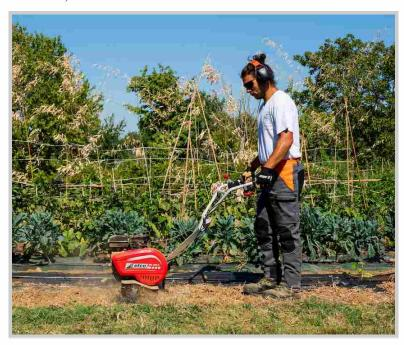
Le nuove motozappe piccole, con fresa da 46 centimetri riducibile a 32-22 centimetri, sono realizzate con materiali in grado di garantire una lunga resistenza e si caratterizzano per una eccellente combinazione di maneggevolezza e facilità d'uso.
