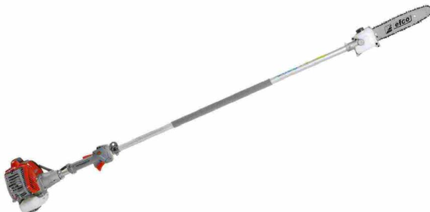
La barra da 10" e la catena da 3/8" x 0,050" conferiscono al potatore ad asta fissa grande versatilità, robustezza e durata. Il motore (con cilindrata di 25 cm<sup>3</sup> e potenza di 1,2 HP) assicura ampiamente le prestazioni necessarie per effettuare i diversi tipi di taglio richiesti dalla potatura.
