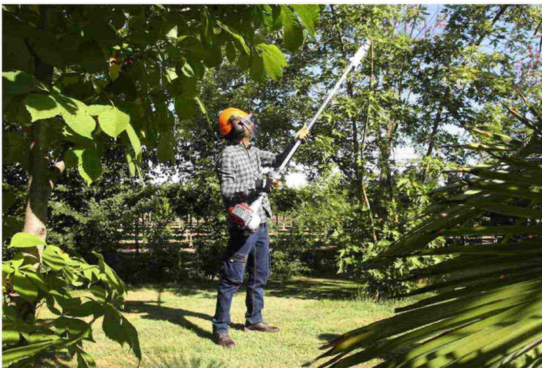
Novità in casa **Emak**: i potatori serie H **Oleo-Mac** PPH 250 ed **Efco** PTH 2500 sono strumenti semplici da manovrare, leggeri ma potenti, progettati per effettuare i lavori di taglio e sramatura in altezza in tutta sicurezza, senza bisogno di utilizzare scale o piattaforme.
