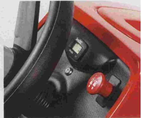
Sopra, il cruscotto fornito di contaore. A lato del volante la frizione elettromagnetica per l'azionamento della lama, solo se l'operatore è al posto guida: la presenza è rilevata da un interruttore posto sotto il sedile.
